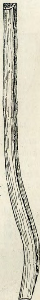
Деревяшка въ профиль для изготовления польской лопаты. Черт. 94.
